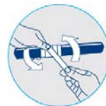
Enrubanner la zone à réparer avec 50 % de recouvrement. Appliquer en plusieurs couches.
