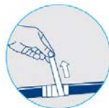
Étirer le ruban jusqu'à 3 fois la longueur initiale pendant l'application.
